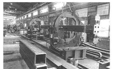
柱大組ロボットも順調に稼働
